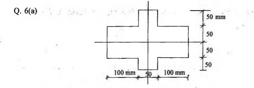
एक घरन का क्रास सेक्सन चित्र में दर्शाया गया है। इस पर ऊर्ध्वाधर अपरूपण बल 10 kN एक निर्धारित खंड पर लगाया गया है। खंड पर अपरूपण प्रतिबल (सियर स्ट्रेस) वितरण ज्ञात करें। A beam has a cross-section shown in figure. It is subjected to a vertical shear force of 10 kN at a given section. Determine the shear stress distribution on the section. 15
