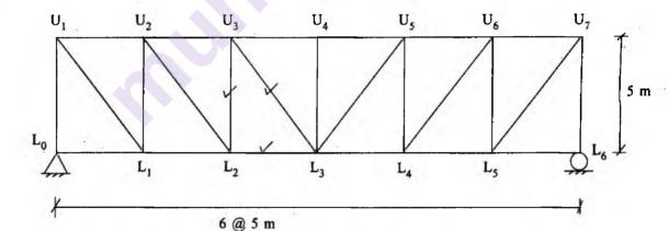
चित्र में दिये गये ट्रस के लिये, इन्फ्लूएन्स लाइन फोर्स इन मेम्बरस  $U_3L_3$ ,  $U_3L_2$  और  $L_2L_3$  के लिये रेखाचित्र बनाइए। भार नीचे के कार्ड पर चल रहा है।
